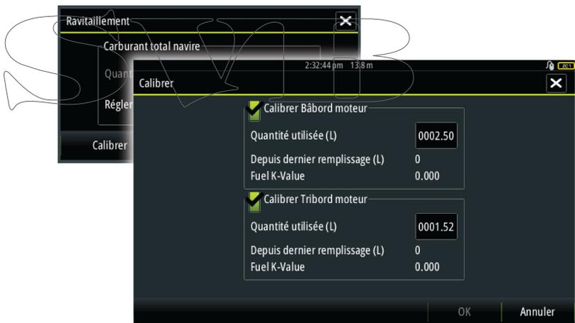
1. Démarrez avec un réservoir plein et faites fonctionner le moteur normalement.
