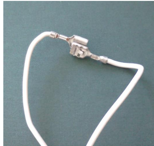
Abb.7a - Geschlossene Leitungen
