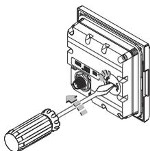
Un port USB se trouve à l'arrière de l'appareil AP44. Vous pouvez utiliser ce port pour les mises à jour logicielles.
