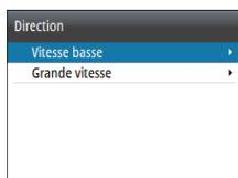
élevée, plus la pression sur la barre est forte. Si la valeur est trop basse, la compensation d'une erreur de cap prendra beaucoup de temps et le pilote automatique ne parviendra pas à maintenir le cap. Si la valeur est trop élevée, le pilote automatique a tendance à surcompenser et le pilotage est instable.
