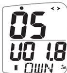
Die Anzahl der Micronet Geräte wird im oberen und die Software Version im unteren Fenster gezeigt. Batteriezustand und Ladungsrate für das aktuelle Display werden durch die jeweiligen Symbole erläutert.
