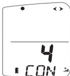
Reguliert den Betrachtungswinkel der Flüssigkristallanzeige um die Sichtbarkeit bei unterschiedlichen Einbauten zu verbessern. Verfügbare Werte sind 1 - 7, wobei 4 die Werkseinstellung ist.
