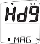
Das System kann so konfiguriert werden, dass es den Kurs entweder MAG (magnetisch) oder TRU (wahr) anzeigt. Die magnetische Variation muss gesetzt werden um die Anzeige des wahren Kurses zu ermöglichen (siehe Abschnitt S4 unten). Ein wahrer Kurs wird durch das TRUE Symbol im oberen Fenster indiziert. Die Abwesenheit dieses Symboles weist auf einen magnetischen Kurs hin.
