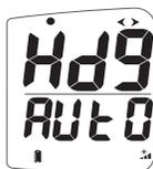
Setzt die Aktualisierungszeit für das Kompassdisplay Auto (automatisch)/SLO (langsam)/mED (mittel)/FAST (schnell).
