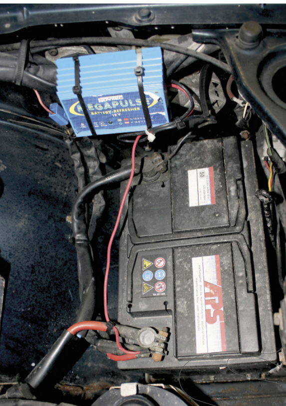
Einmal mit und einmal ohne Megapulse: Im VR-Test startete nur das gepulste Fahrzeug nach längerer Standzeit noch problemlos
