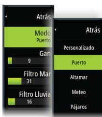
sotavento del filtro de mar. La GANANCIA del receptor del radar aumenta dinámicamente durante el barrido, en dirección sotavento, para aumentar la visibilidad del blanco cuando el mar está agitado.
