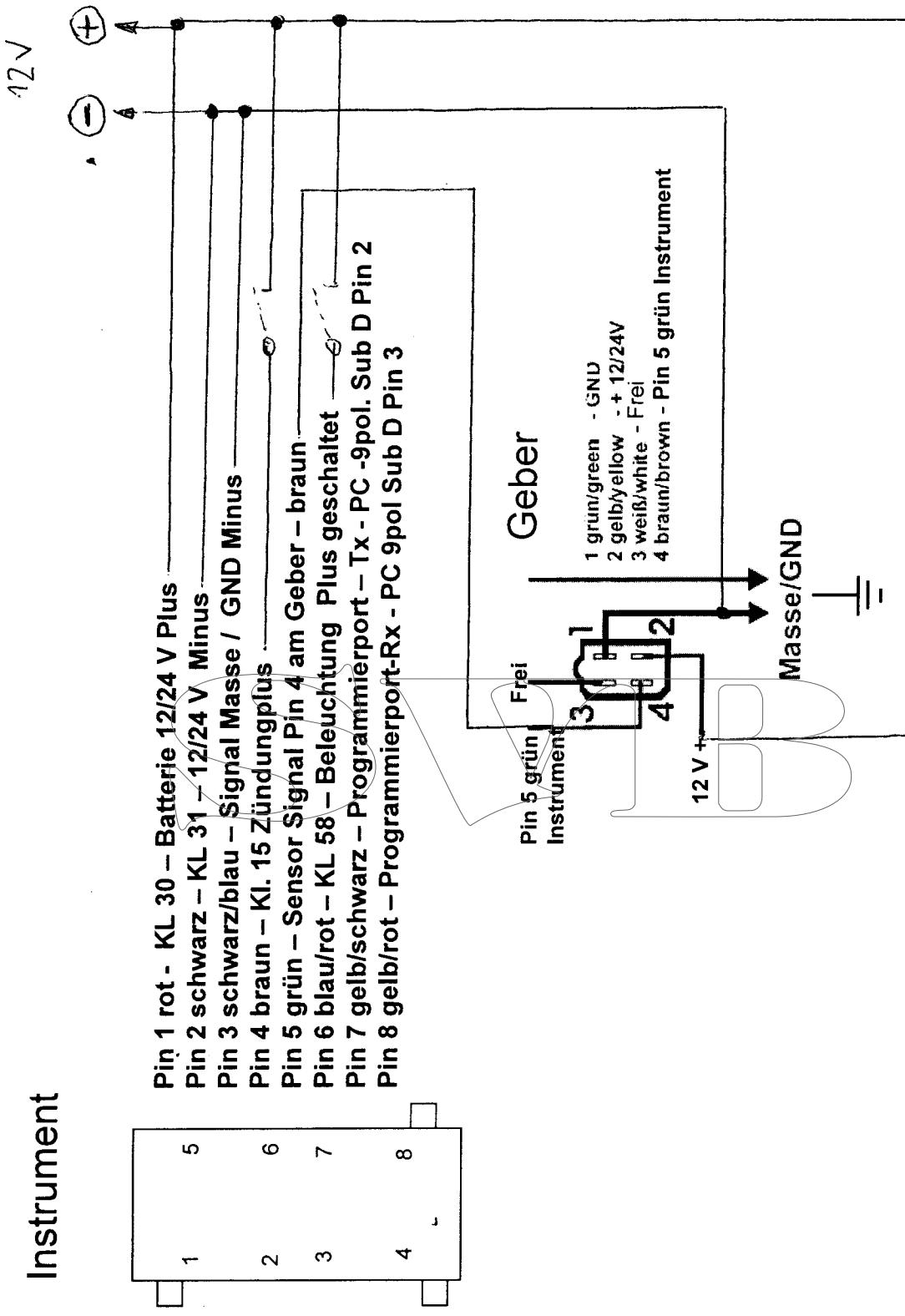
Pin 7 + 8 am Instrument wird nur zum Programmierten der Warnpunktes über PC benötigt.
