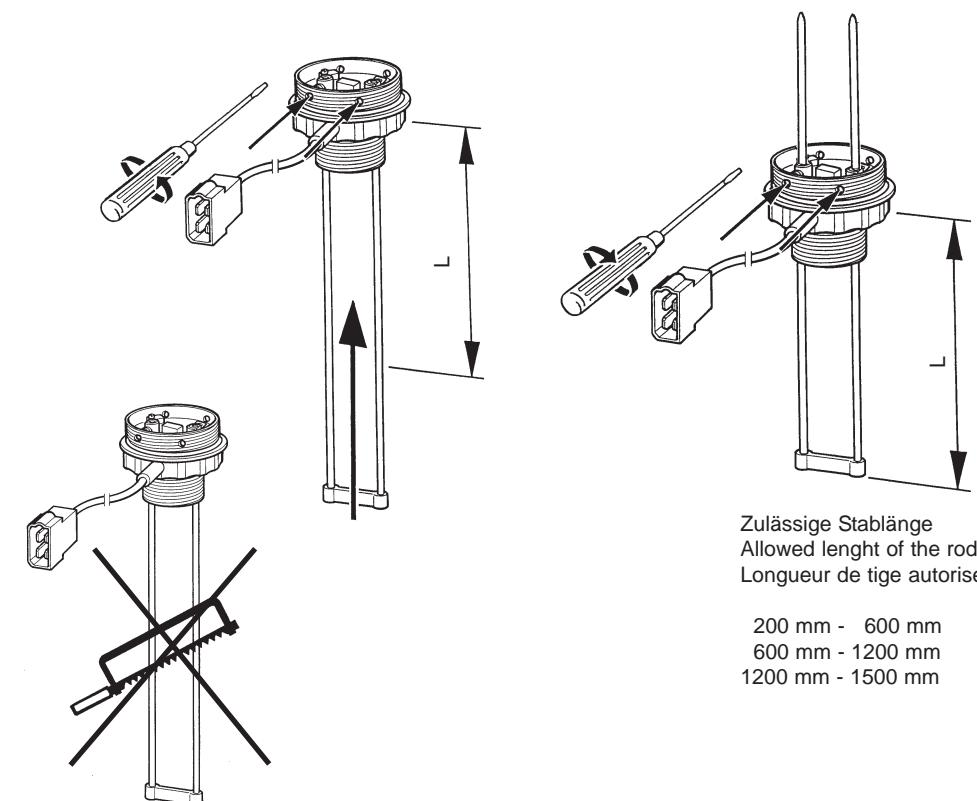
Beschädigen Sie nicht die Oberfläche des lackierten Rundstabes. Kürzen Sie die Rundstäbe nur oben. Die gekürzten Rundstäbe dürfen nicht entfernt werden, da beim Wiedereinsetzen der Stäbe Dichtringe beschädigt werden können.
