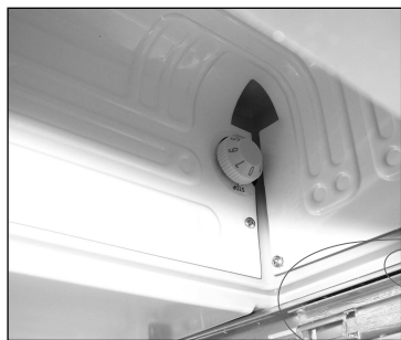
Plaatsing thermostaat, op achterwand rechts.
