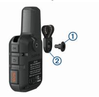
2 Fissare l'adattatore per il montaggio sul telaio ① alla parte posteriore del dispositivo mediante la vite lunga ② in dotazione.
