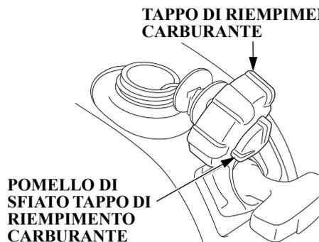
Aprire il pomello di sfiato tappo di riempimento carburante (vedere pagina 23). Rimuovere il tappo di riempimento del carburante e controllare il livello del carburante. Riempire il serbatoio se il livello del carburante è basso.
