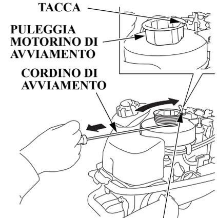
14. Porre l'estremità annodata della fune del motorino di arresto di emergenza nella tacca della puleggia del motorino di avviamento tirando la fune di avviamento di emergenza in senso orario attorno alla puleggia del motorino di avviamento.
