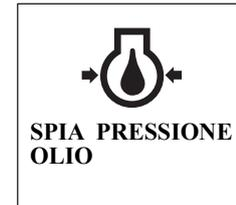
Quando il livello dell'olio motore è basso o il sistema di lubrificazione del motore è difettoso, la spia pressione olio si spegne e il sistema di protezione del motore limita il regime motore.
