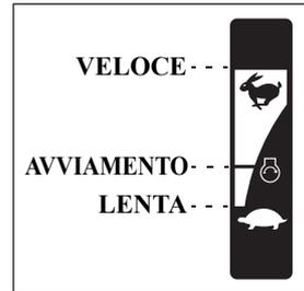
Ruotare la manopola dell'acceleratore in senso orario o in senso antiorario per regolare il regime motore. Ruotando la manopola dell'acceleratore nella direzione indicata dalla freccia, il regime motore aumenta.
