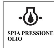
7. Dopo l'avviamento del motore, verificare che la spia pressione olio motore sia accesa. Se non è accesa, spegnere il motore ed eseguire i seguenti controlli.
