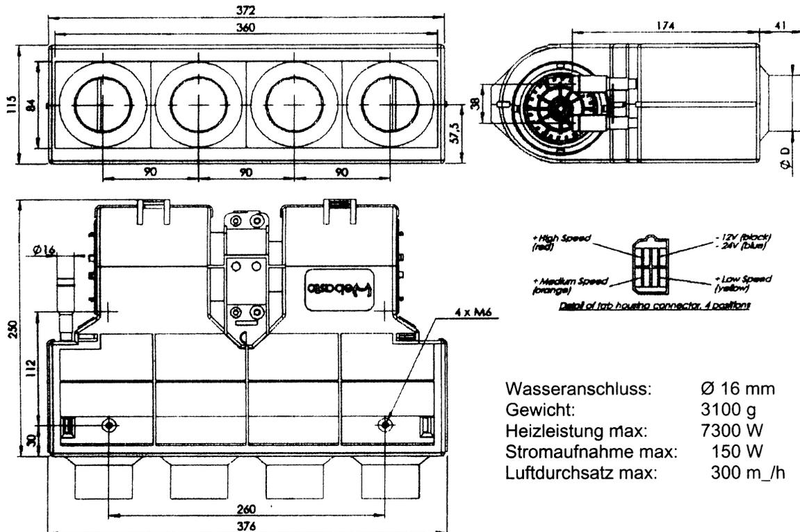
Wasseranschluss:  $\varnothing$  16 mm
