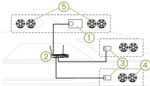
Nell'immagine precedente, uno stereo Apollo RA770 (1) è connesso a un router wireless (2) e a due stereo a zone Apollo SRX400 (3). I due stereo a zone FUSION PartyBus possono riprodurre in streaming le sorgenti dello stereo FUSION PartyBus.
