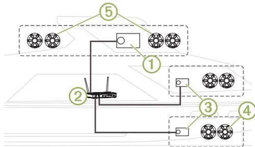
Sur l'image ci-dessus, une chaîne stéréo Apollo RA770 ① est connectée à un routeur sans fil ② et à deux zones de stéréo Apollo SRX400 ③. Les deux zones de stéréo FUSION PartyBus peuvent diffuser des sources depuis la chaîne stéréo FUSION PartyBus.
