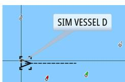
Quando si seleziona un'icona AIS sul riquadro radar o cartografico, il simbolo diventa un simbolo target selezionato e viene visualizzato il nome dell'imbarcazione.
