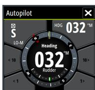
In caso di connessione di Zeus<sup>2</sup> a un sistema di pilota automatico che include un'unità di controllo AP24 o AP28, solo un'unità di controllo può essere attiva contemporaneamente. Un'unità di controllo inattiva è indicata da un quadrato con un simbolo a forma di croce nel popup del controller del pilota automatico.
