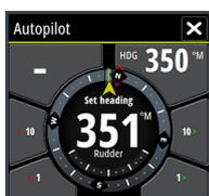
Se Zeus<sup>2</sup> è collegato a un sistema EVC tramite SG05, è possibile assumere il controllo manuale del timone anche se è attiva la modalità Pilota automatico.
