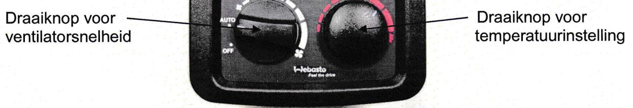
De draaiknop voor de ventilatorsnelheid heeft 7 standen: uit (Off), Automatisch (Auto), en vijf standen om de ventilator handmatig te bedienen. De knop voor de temperatuurinstelling is traploos. De aanwijzers van beide knoppen worden rood verlicht.
