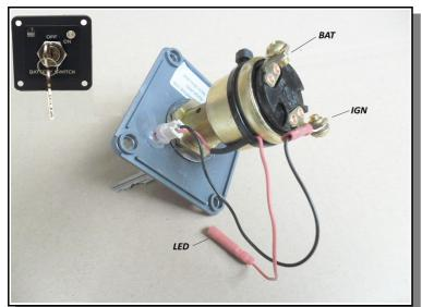
Das Schaltpanel ist sofort als Ersatzteil für die BEPMARINE Produkte 701-MD, 720-MD und 722 einsetzbar, da die LED-Betriebsanzeige passend vorverdrahtet ist. Bei diesen Produkten wird die MINUS-Leitung eines Stromkreises geschaltet. D. h. die Schalterkontakte BAT und IGN liegen in der MINUS-Leitung. Passend dazu muss der bewegliche rote Draht der LED-Betriebsanzeige an PLUS 12 Volt angeschlossen werden.
