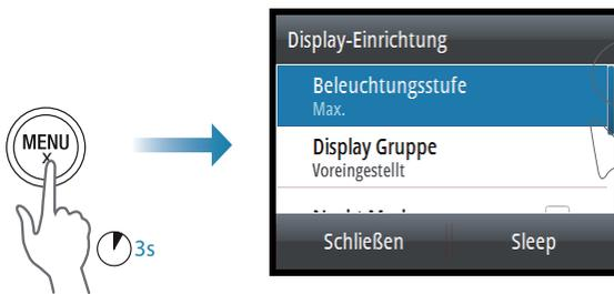
Wenn das Feld für die Beleuchtungshelligkeit aktiviert ist, kann durch aufeinanderfolgendes Drücken der **MENÜ** Taste die Beleuchtungshelligkeit in Schritten von 30 % angepasst werden.
