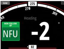
Im NFU-Modus können Sie die Backbord- und Steuerbord-Tasten am Bedienfeld zur Steuerung des Ruders verwenden. Das Ruder bewegt sich so lange, wie die Taste gedrückt wird.
