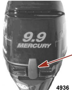
2. Levantar la parte delantera de la cubierta para librar el pestillo delantero y empujarla hacia la parte trasera para librar el gancho trasero.
