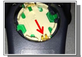
Die beiden nebeneinander liegenden Kontaktzungen dürfen keinesfalls nach oben gebogen sein oder seitlich an der Knopfzelle anliegen. Sie müssen die Unterseite der Knopfzelle berühren. Siehe Abb. unten.
