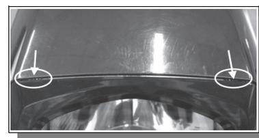
3. Entfernen Sie die 6 Schrauben mit denen Lampenglas und Reflektor am Scheinwerfergehäuse festgeschraubt sind.
