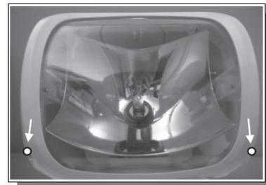
2. Der Frontrahmen wird an der Oberseite von zwei Snap-Nasen am Scheinwerferglas gehalten. Stecken Sie die Klinge des Schlitz-Schraubendrehers vorsichtig in die markierten Bereiche zwischen Frontrahmen und Scheinwerfergehäuseoberseite (siehe Abb.). Hebeln Sie den Frontrahmen ebenso vorsichtig aus seiner Verriegelung.
