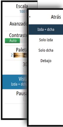
La vista en 2D puede configurarse como una imagen DownScan o como una imagen SideScan que muestre un escaneado lateral a la izquierda, la derecha o derecha+izquierda.
