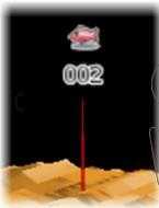
Si el cursor se coloca en una imagen 3D, no se incluye información de profundidad para el waypoint. El waypoint en una imagen 3D se dibuja con una línea bajo él para indicar su ubicación en el fondo marino.
