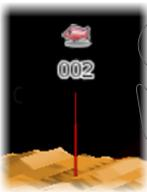
Wenn der Cursor auf einem 3D-Bild positioniert wird, werden keine Tiefeninformationen für den Wegpunkt angegeben. Auf einem 3D-Bild wird der Wegpunkt mithilfe einer unter ihm liegenden Linie angezeigt, um seine Position auf dem Meeresboden anzugeben.
