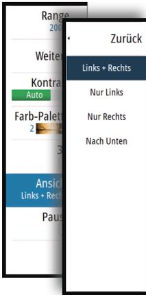
Die 2D-Ansicht kann als DownScan-Bild oder als SideScan-Bild für die Darstellung des linken/rechten Scan-Felds oder des linken und rechten Scan-Felds eingerichtet werden.
