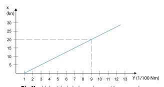
**Eje X** = Velocidad de la embarcación en nudos **Eje Y** = Círculo de llegada, radio en 1/100 nm
