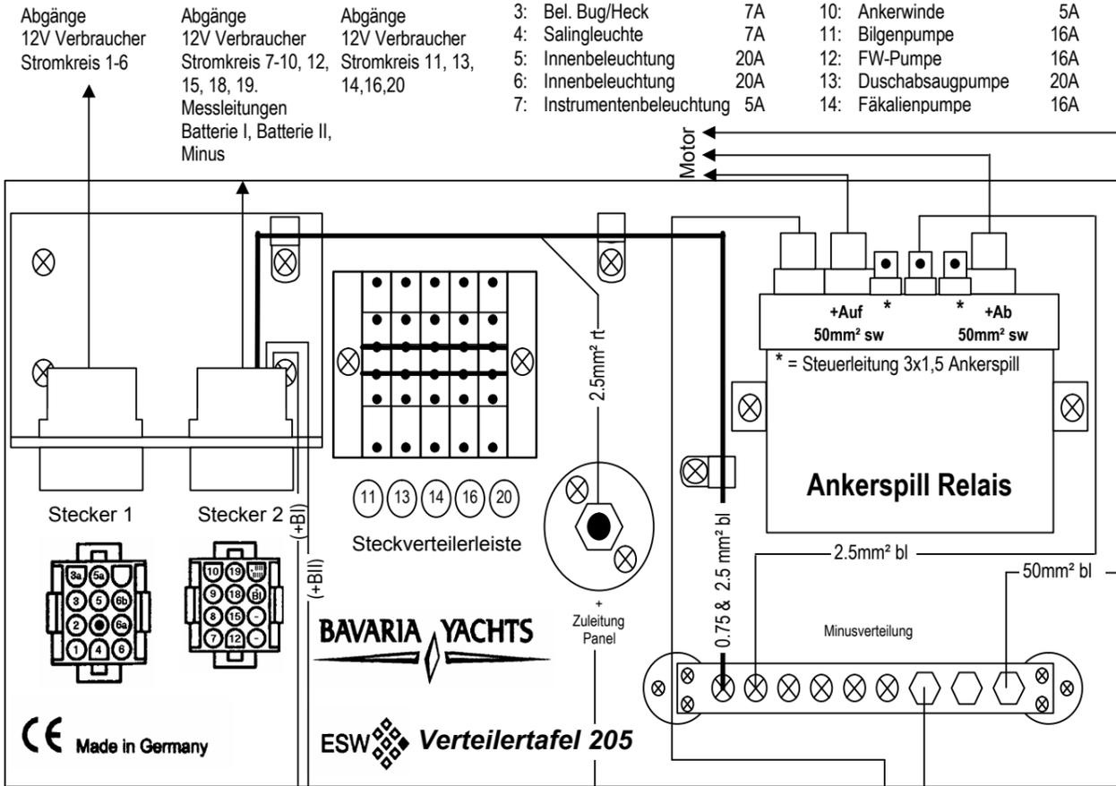
Alle 12V Leitungen vom Panel 201 zur Verteilertafel 205 jeweils mit der entsprechenden Nummer oder Bezeichnung auf der Verteilertafel verbinden.
