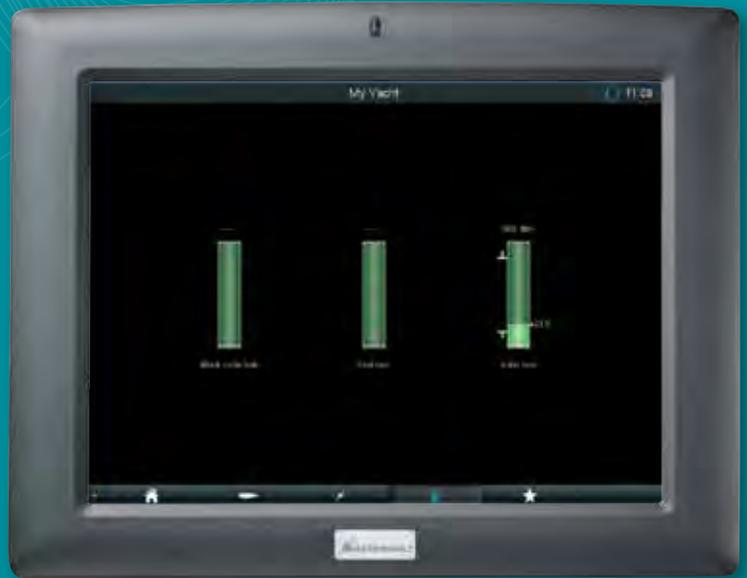
**Tankanzeigen Seite:** Mit allen Information von bis zu 10 Tanks. Voll- und Leerpegelalarne können gewählt und gesetzt werden. Alle Tankanzeigen, die mit dem MasterBus verbunden sind werden automatisch erkannt und dargestellt.
