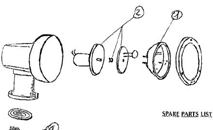
1 70001012/24 SEALED BEAM 12 V. / 24 V.
