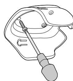
Fixieren Sie die Ablageschale jetzt mit den 3 Schrauben auf der Montagefläche.
