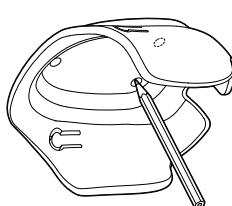
3. Bohren Sie die Führungslöcher vorsichtig an, um Schäden an der Montagefläche zu vermeiden.
