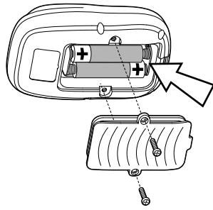
Setzen Sie die 2 AAA-Batterien ein (im Lieferumfang!). Wenn Sie sie später einmal ersetzen, nehmen Sie nur hochwertige Alkaline AAA-Batterien.
