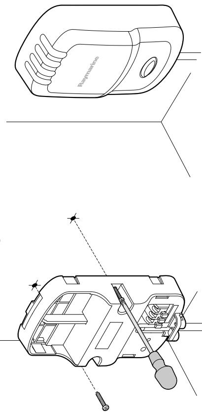
**5.** Mit den beiden Schrauben Nr. 6 sichern Sie die Basisstation auf der Montagefläche.
