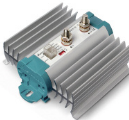
Battery Watch multi usages pour 12 ou 24 V CC, courant maximum 150 A. Voir fiche de spécifications séparées pour des informations détaillées.
